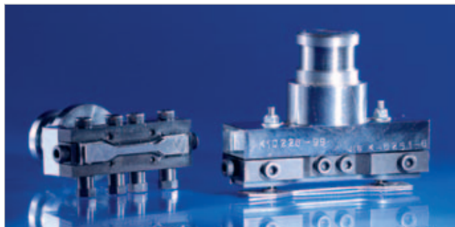
Stanzwerkzeuge für die Herstellung von Normprüfkörpern
