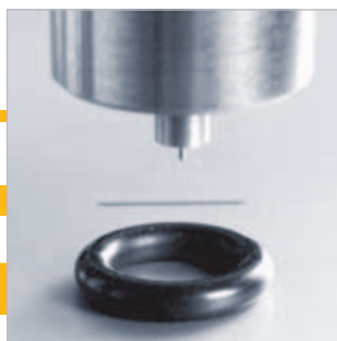
Zerreißprüfung (linke Abb.) und Härteprüfungen von Elastomeren
