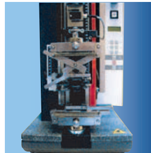
Zerreimaschine zur Bestandigkeitsprufung von Elastomeren und Kunststoffen in Bezug auf unsere Qualitaten
